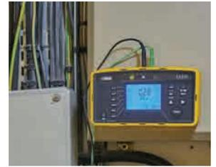
Boîtier aimanté pour fixation magnétique
